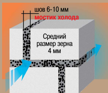
Традиционный строительный раствор
